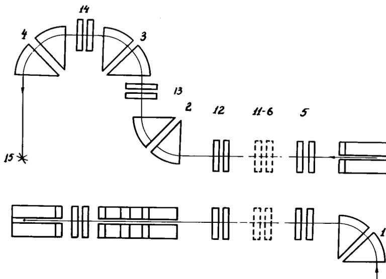
Рис.1 Трасса пучка на неумножающую мишень / вверху - в горизонтальной, внизу - в вертикальной плоскостях /.
