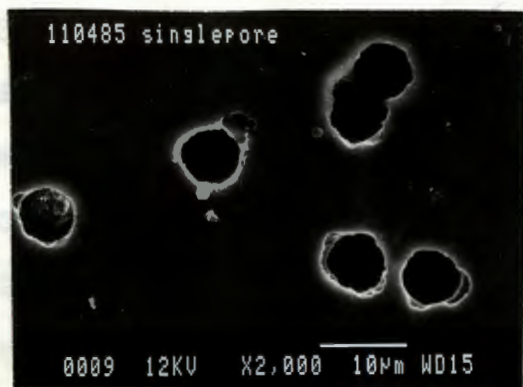
Рис. 2в. Электронная микрофотография участка поверхности мембраны, содержащей несколько десятков пор.
