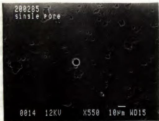
Рис. 2а. Электронная микрофотография поверхности мембраны с единственным отверстием. Увеличение 550X.
