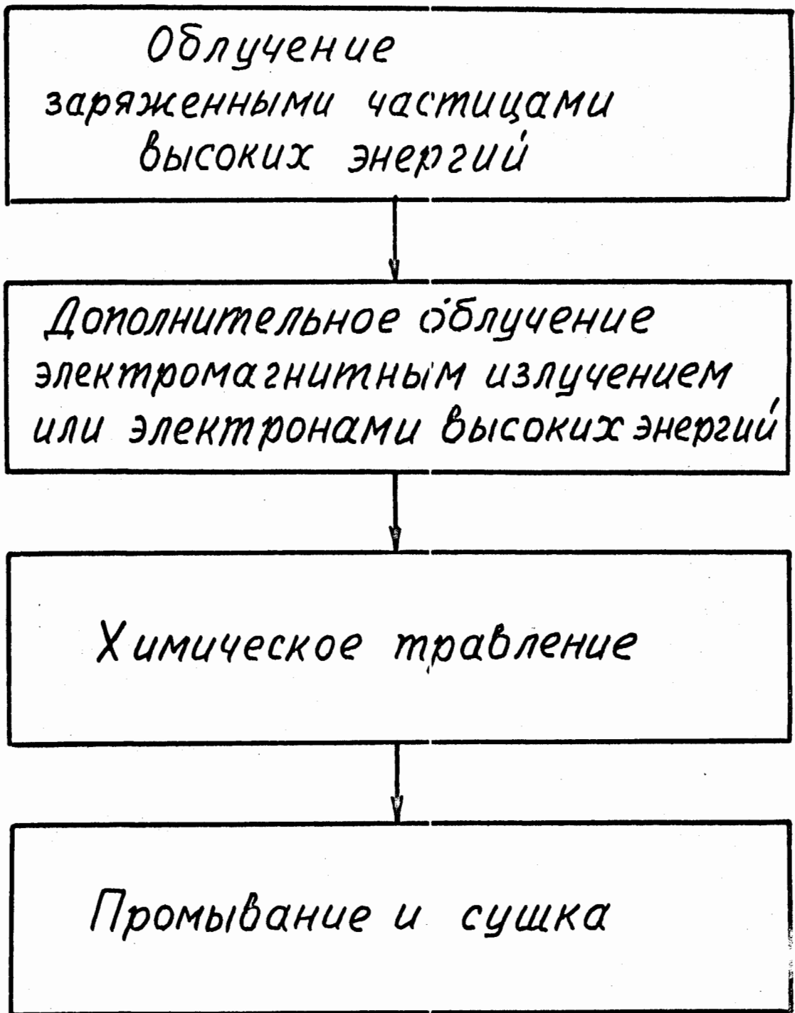
Рис 1 Основные этапы технологического процесса изготовления фильтрующей перегородки ядерного фильтра
