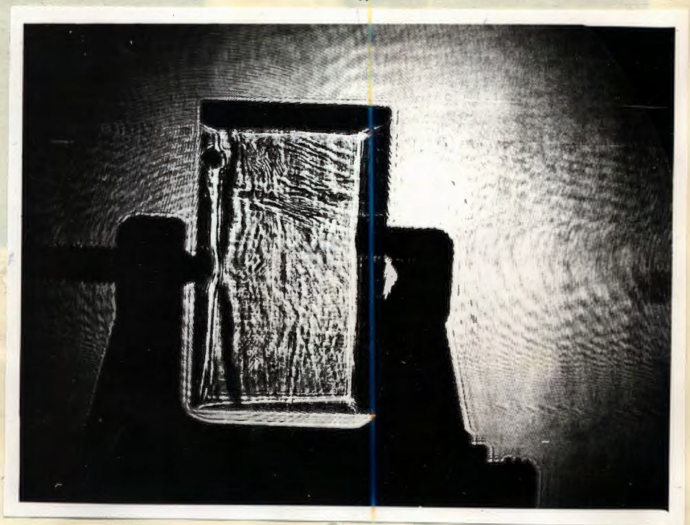
Рис. 28. Визуализация внутренних напряжений в оптически прозрачной пластинке с плоскими оптическими свойствами а/ Пластинка из оргстекла в свободном состоянии б/ Та же пластинка в сжатом состоянии. Диаметр сжимающего винта равен 4 мм.
