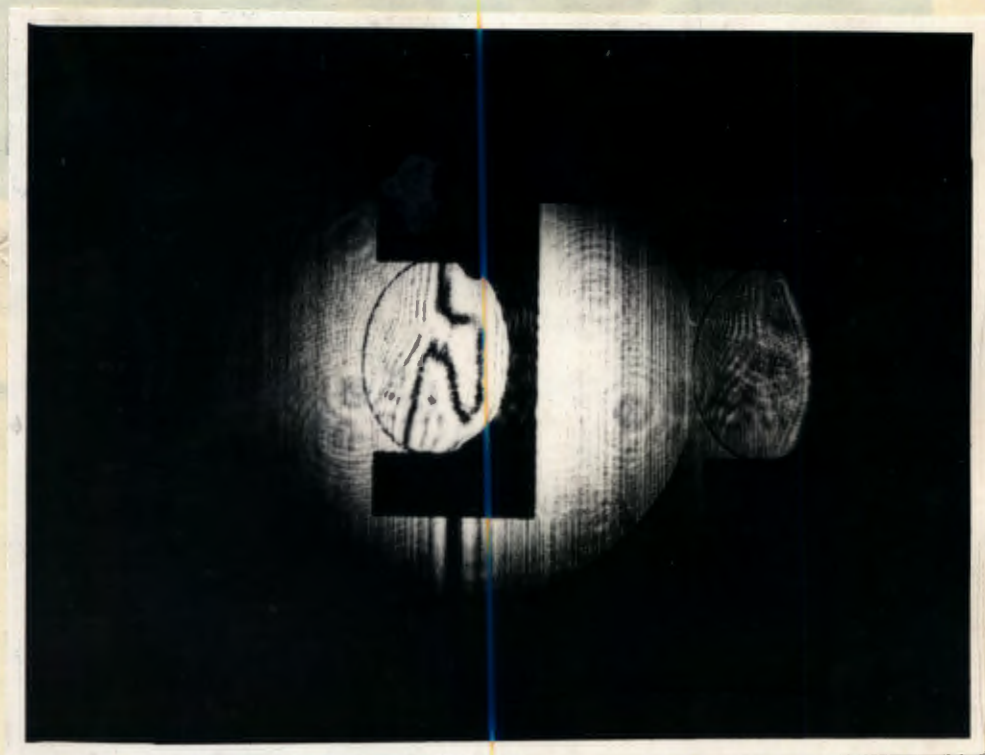
Рис. 32. Визуализация оптических неоднородностей с помощью дифракционной решётки со сбоем, расположенной вне плоскости пространственных частот. Тёмная линия идёт параллельно большой оси овала.
