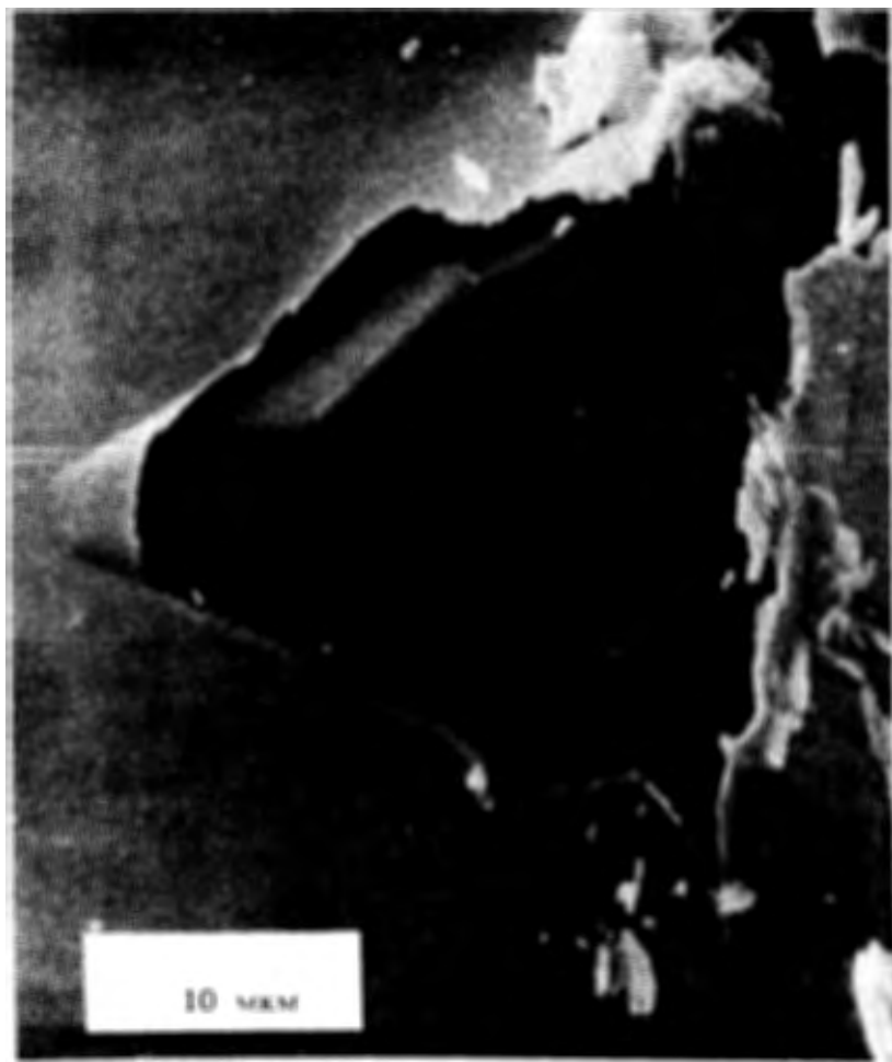
Рис. 6. Поверхность разорванной пленки вольфрама на подложке из кремния.
