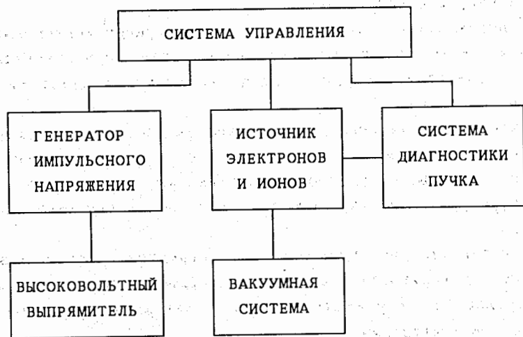
Рис. 1. Структурная схема установки для исследования формирования импульсных электронных и ионных пучков.
