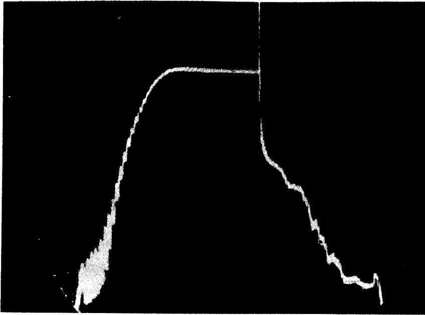
Рис. 4. Напряжение падающей волны в фидере во время пробоя в резонаторе.
