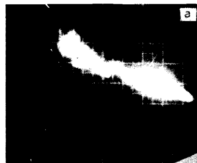
Рис.7. Осциллограммы сигналов, измеренных с помощью пояса Роговского /9 на рис.1/: а - при p = 0,18 ; б - при p = 0,54 . Развертка: а - 50 нс/дел, б - 100 нс/дел.
