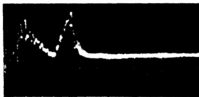
Рис.4. Осциллограммы импульсов ускоренного пучка на различных радиусах циклотрона. Первый пик - импульс общего тока лазерной плазмы, второй - импульс ускоренного пучка.
