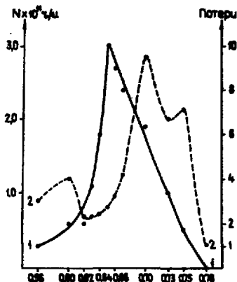
Рис. 1. Распределение по радиусу показателя магнитного поля, усредненного по 42 полюсам магнита, на поле 160 Гс до корректирования /1/ и после /2/ при токе в цикле размагничивания 800 А.
