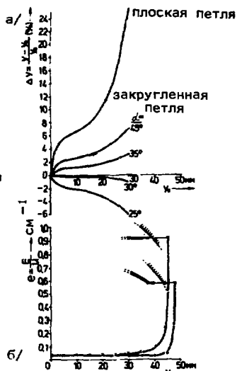
Рис.11. Действие закругления пластин /а/ и максимальная напряженность на ее крае /б/.
