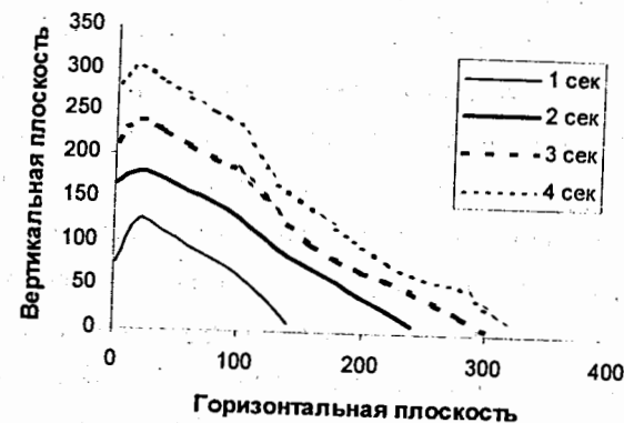
Рис. 4. Начальные значения инвариантов Куранта-Снайдера дейтрона в п-мм-мрад, которые охлаждаются до аксептанса Нуклотрона в течение фиксированного промежутка времени.
