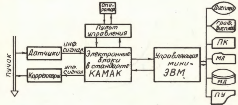
Рис. 3. Блок-схема коррекции замкнутой орбиты.
