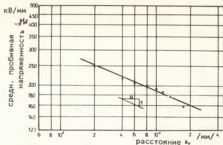
Рис. 6. Зависимость средней пробивной напряженности от расстояния между электродами /пропитка: касторовое масло/.
