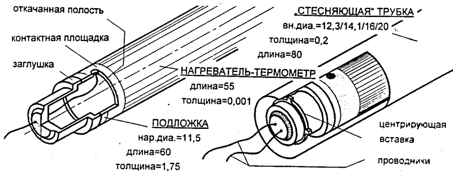
Рис. 1. Конструкция образца и способ создания стеснённых условий (все размеры - в мм).
