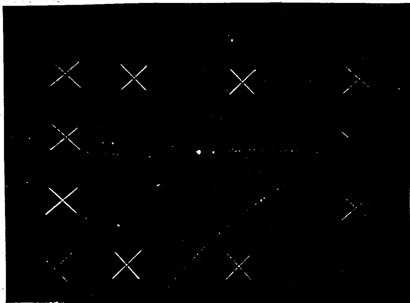
Рис.5. Следы частиц, полученные на спектрометре РИСК при облучении мишени с жидким водородом пучком \pi -мезонов с энергией 25 ГэВ на ускорителе ИФВЭ.
