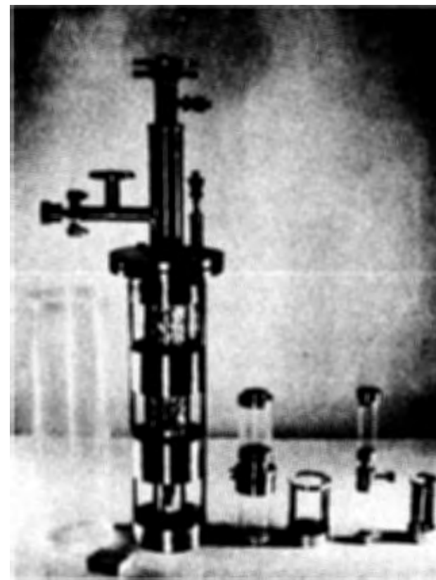
Рис.1. Основные элементы криогенной мишени. Слева направо: лавсановая обечайка вакуумного кожуха, вакуумный кожух, внутренние сосуды для водорода и дейтерия \varnothing 50 \text{ мм} , экран дейтериевого сосуда \varnothing 50 \text{ мм} , внутренние сосуды для водорода и дейтерия \varnothing 25 \text{ мм} , экран дейтериевого сосуда \varnothing 25 \text{ мм} .
