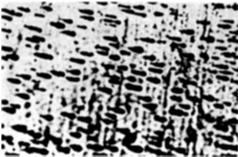
Рис. 2в. Микрофотографии следов ионов с энергией \sim 1 МэВ/нуклон в фторопластах Ф-23 (угол входа в пластик ионов хрома - 45^\circ ) и Ф-23 (угол входа в пластик ионов криптона - 30^\circ ). Увеличение 1800X.
