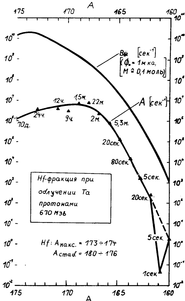
Рис 1. Ожидаемые скорости образования V_{oi} и активности A изотопов Hf из Ta - мишени при I_{бне} = 1 мка, M = 0,1 моль, T_{тр} = 10 сек и \epsilon = \prod \epsilon_j = 10^{-2} .
