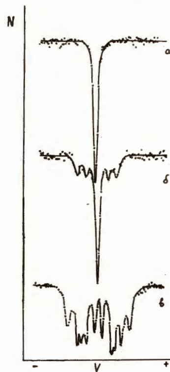
Рис. 5. Мёссбауэровские спектры сплава Fe_3Al (24,3 ат.% Al) при температурах: а) 700 °C; б) 550 °C; в) 20 °C.
