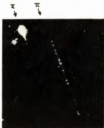
Рис. 13. Фотография трека \pi^- -мезона с энергией 15 Мэв, проходящего через камеру.
