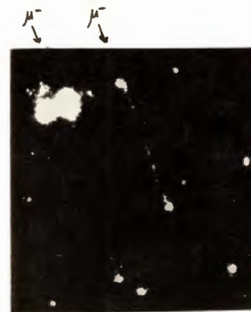
Рис. 15. Фотография остановки мюона в неоне, полученная при повышенном газовом усилении.
