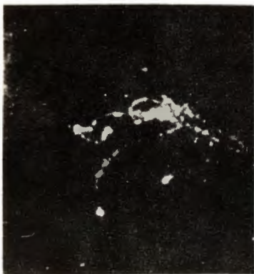
Рис. 17. Фотография фонового электрона в камере с временем чувствительности порядка 10^{-4} сек.
