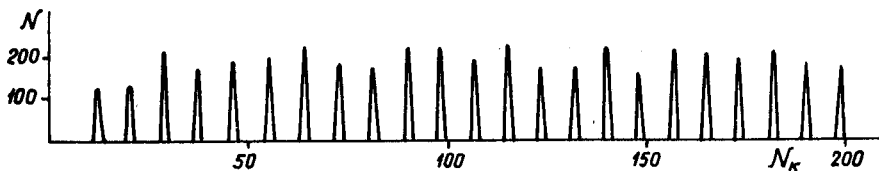
Рис. 15. Спектр от шумов двух ФЭУ, модулированный частотой 5 Мгц.
