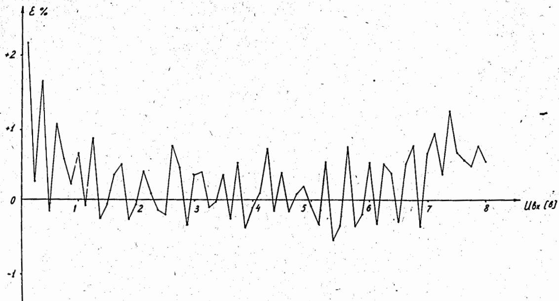
Р и с. 10. Кривая дифференциальной нелинейности амплитудного кодировщика.
