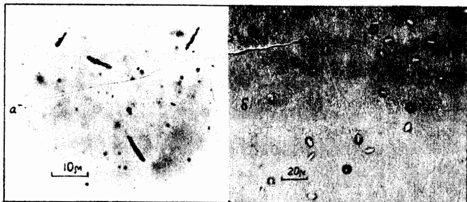
Рис. 1. Следы осколков деления а) ядерные эмульсии П-8, б) силикатные стекла.
