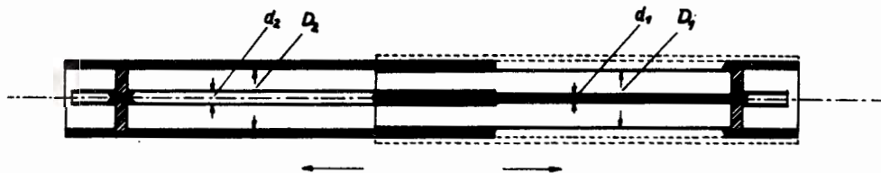
Рис. 1. Принцип устройства переменной линии задержки. Пунктиром показана внешняя оболочка, которая обеспечивает необходимую механическую устойчивость.
