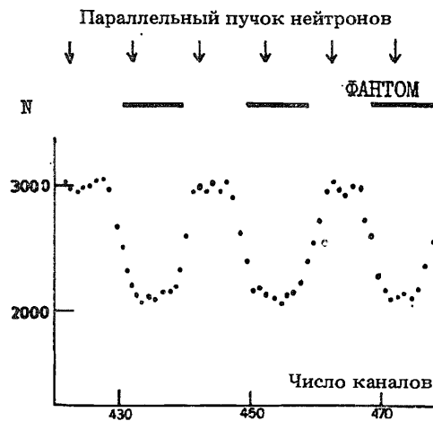
Рис.4. Профиль нейтронного пучка после его прохождения через фантом из кадмия. (Стрипы шириной 2 мм с шагом 2 мм, толщина кадмия 1 мм); Получено на многоканальном анализаторе; цена канала 0,22 мм. Рабочий режим детектора: p = 5 Тор; U_A = 460 В; U_P = 530 В; U_T = 50 В.
