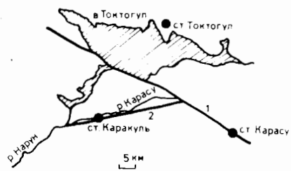
Рис.2. Схема расположения пунктов измерения почвенного радона в районе Токтогульского водохранилища.
