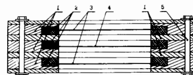
Рис. 11. Мониторная проходная плоскопараллельная ионизационная камера. 1 - корпус камеры с охранными кольцами, 2 - держатели электродов, 3 - высоковольтные электроды, 4 - собирающий электрод, 5 - крепящие шпильки.
