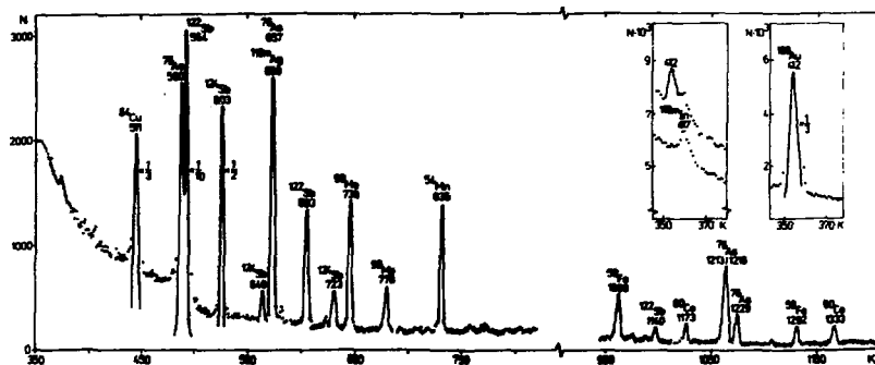
Рис. 5. Спектр гамма-квантов от образца медно-молибденового концентрата.
