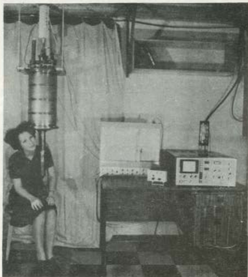
Рис.1. Общий вид магнитокардиографа. Слева - криостат, внутри нижнего отростка которого размещен датчик КСИ /сквид/. Снаружи отростка закреплено компенсационное кольцо, сверху на криостате - блок радиотехники КСИ. Справа - анализатор, самописец и блок питания КСИ.
