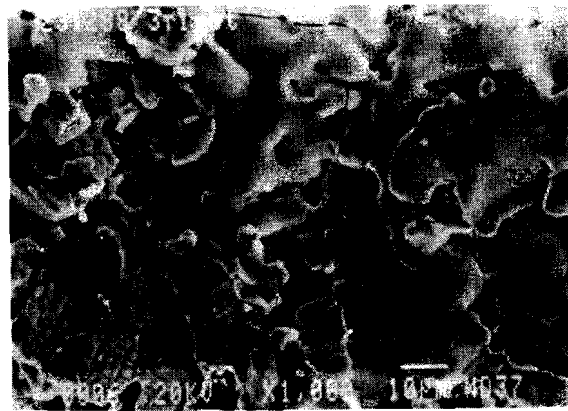
Рис. 6б. Фотография поверхности Y-Ba-Cu-O после облучения.
