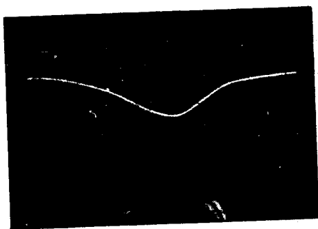
Рис. 9. Входной импульс длительностью 50 нсек /а/, подаваемый на вход усилителя; выходной импульс усилителей, собранных на различных триодах: /б/ - П411А, /в/ - П410А, /г/ - П416Б, /д/ - П415А. Цена большого деления по горизонтали - 10 нсек, по вертикали - 0,2 в.
