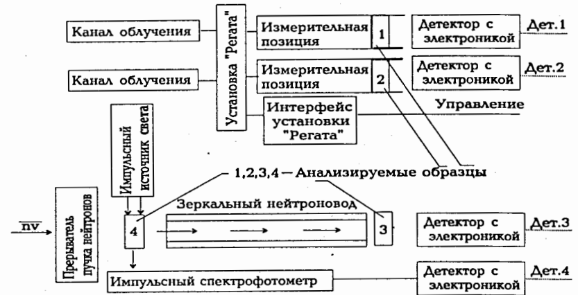
Рис.2.5 Физическая аппаратура модуля элементного анализа и радиационных исследований на ИБР–2.
