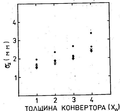
Рис.7. Зависимость пространственного разрешения \sigma_z от толщины конвертора: \circ - метод АЦП-ц.т., \bullet - ВЦП, \times - АЦП-макс., + - АЦП-в.м.
