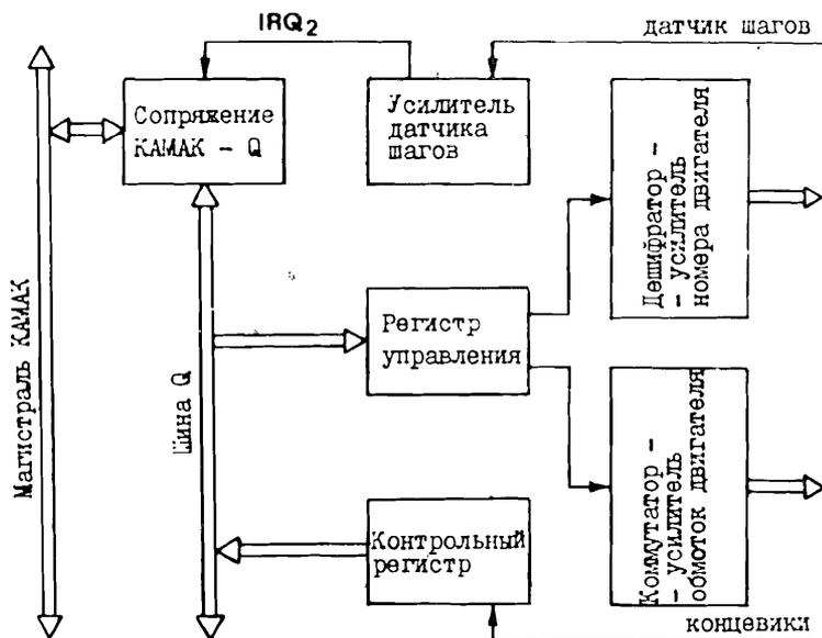
Рис. Блок-схема БУШД-3.
