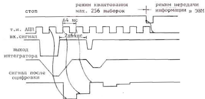
Рис. 1. Принцип работы модуля квантования сигнала.
