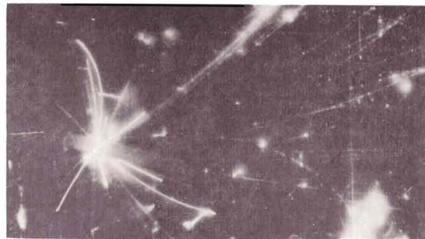
Рис.7. Следы частиц, полученных при облучении стримерного спектрометра СКМ-200 с мишенью повышенного давления, заполненной ксеноном в пучке ядер ^{16}\text{O} при энергии 3,7 ГэВ на нуклон.
