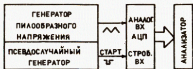
Рис.5. Блок-схема применения генератора пилообразного напряжения и генератора псевдослучайных импульсов для исследования АЦП в режиме стробирования.
