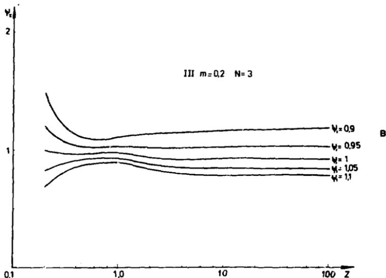
◀ Рис.9. Зависимость  $\Psi_2$  от  $Z$  при  $\Delta x = 0$ ,  $\Psi_1 = \text{const}$ ,  $N = 1,3$ .
