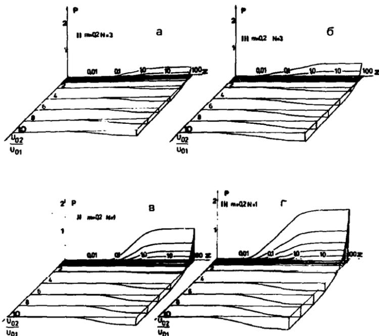
Рис.8. Зависимость изменения времени привязки на выходе второго и третьего каскада от коэффициента перегрузки  $Z$
