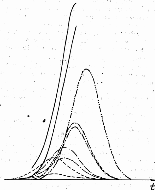
Рис. 4. Образование временной неопределенности переднего фронта импульса ФЭУ: а/ импульс фотоэлектронов, б/ реакция на него диодной системы.
