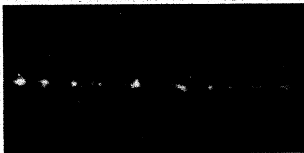
Рис.7. Фотография трека электрона при p = 6 атм.
