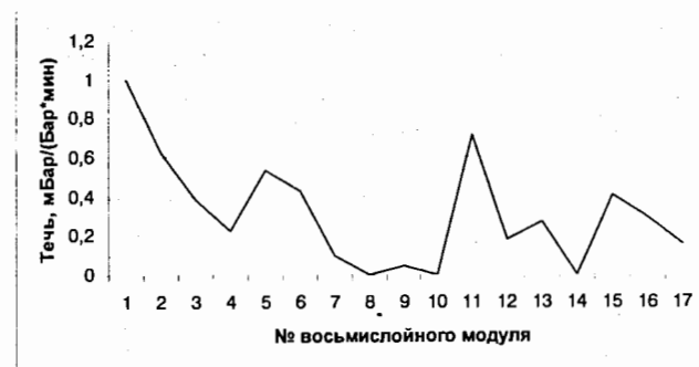
Рис. 7. Газовые течи модулей по результатам финального газового теста
