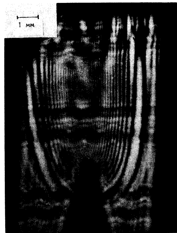
Рис. 6. Габоровская голограмма искры в водороде, задержка 400 \cdot 10^{-9} с, видна дифракционная картина от проволочных электродов.
