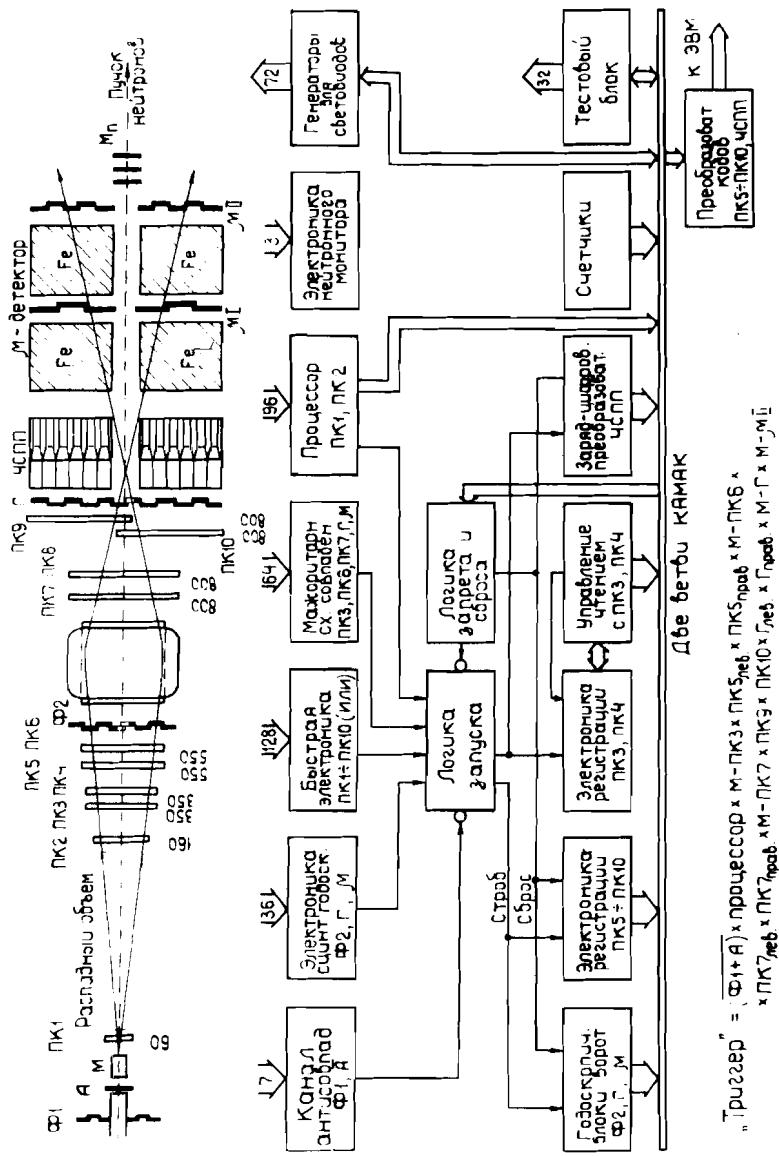
Схематическое расположение детекторов установки и структурная схема электроник запуска и регистрации данных.
