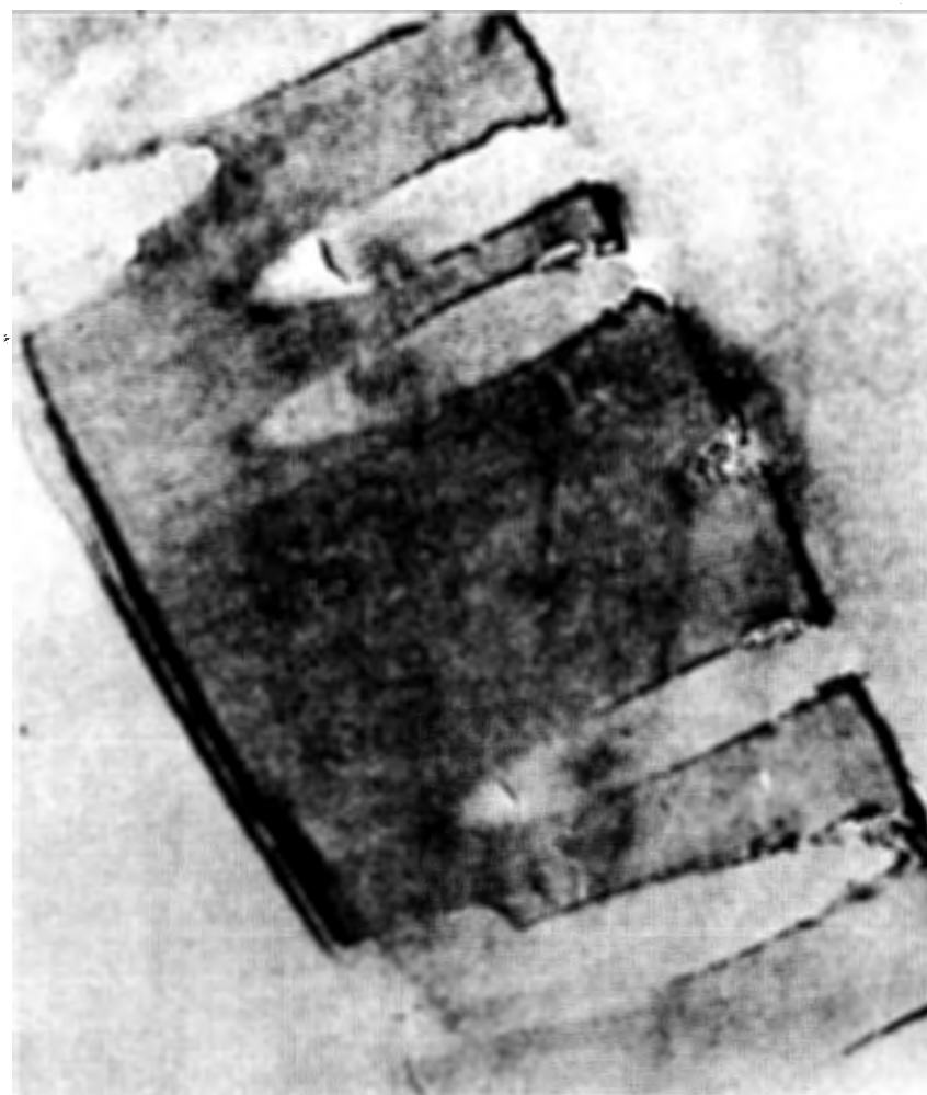
Рис. 3. Электронная микрофотография поперечного среза ядерного фильтра с диаметром пор 0,952 мкм. Увеличение - в 10500 раз.
