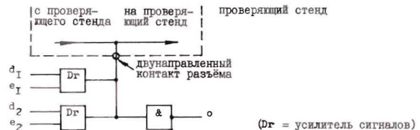
Рис. 4 Пример простой двунаправленной шины с тремя состояниями
