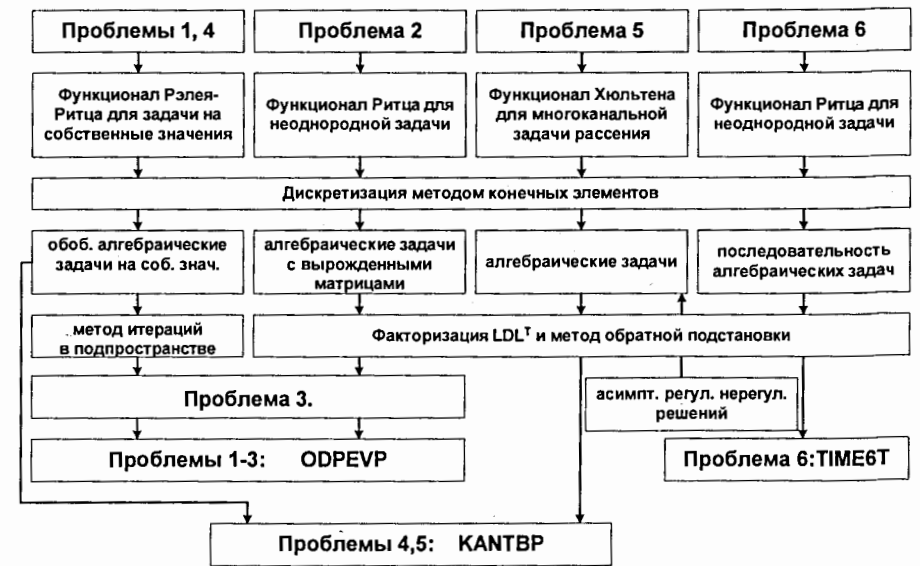
Рис. 1. Структурно-функциональная схема решения проблем 1–6.
