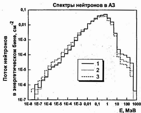
Рис. 4: Спектр нейтронов в активной зоне в трех экспериментальных каналах (1 - рядом с мишенью, 2 - в середине топливной части, 3 - рядом с отражателем).
