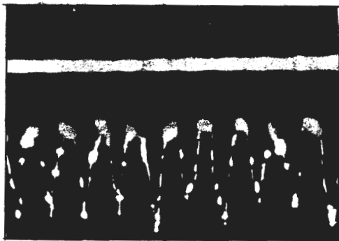
Рис. 8. Осциллограмма сигнала от сцинтилляционного зонда при раскачке фазовых колебаний фольгой из мейлара, толщиной 250 микрон. Временной интервал между высокочастотными импульсами составляет 0,7 мсек.
