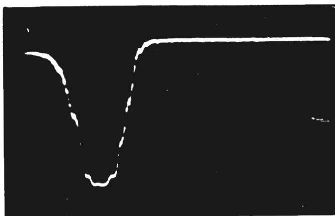
Рис. 4. Осциллограмма тока частиц на мишень. Длительность развертки 25 мсек.
